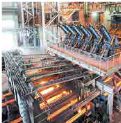
Мал. 73. Машина безперервного лиття заготівель конвертерного цеху ПАТ «АрселорМіттал Кривий Ріг»
