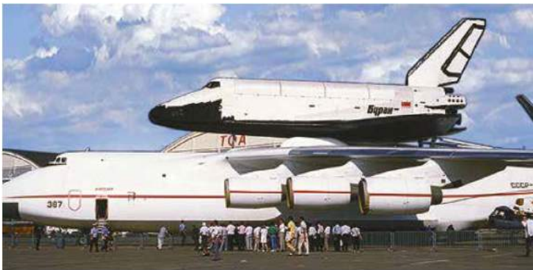
▲ Літак Ан-225 «Мрія» – транспортний літак надвеликої вантажопідйомності. Є найбільшим вантажопідйомним літаком у світі. Спроектований і побудований у Києві в 1984–1988 рр.
